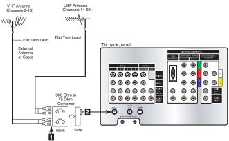
Figure 1. Connecting separate UHF and VHF antennas.
